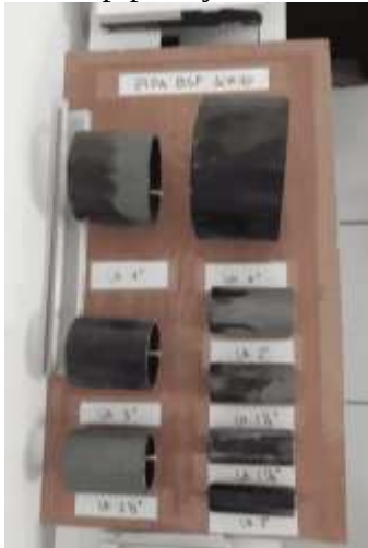
Gambar 4. Mock-up pipa hydrant sprinkler yang digunakan pada proyek
