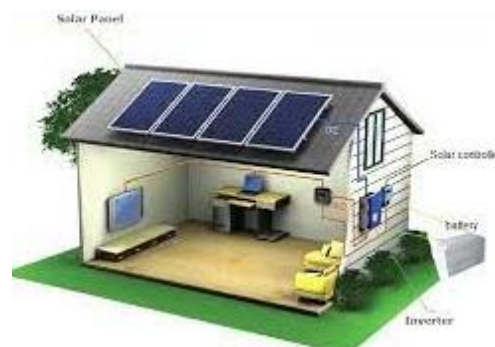
Gambar 2.1 PLTS Off Grid pada Rumah Tinggal (sumber Sentra Energi)
